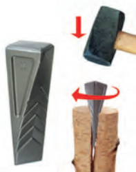
FALÇA HELICOIDAL ALUMINI PER PARTIR TRONCS 9684280 20cm. 800 gr. La seva forma helicoidal facilita el badat del tronc a cada cop, trenca per rotació. Amb doble ranura i ranures antiretorn.
