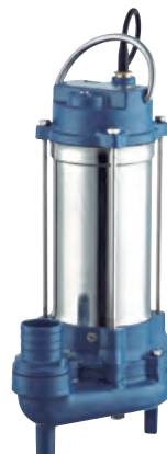
ELECTROBOMBA CAMPEON ITIP-1000 9685463 ELECTROBOMBA CAMPEON ITIP-1000. 1000W. Apta ús continu. Drenatge potent aigües brutes (Ø màx38mm pas sòlids). Cabal 19.200l/h. Alçada màxima 11m R. 1 «1/2H - rècords 40 / 50mm. Profunditat màx immersió 7mt. Maneta ergonòmica. Funcionament MAN o AUT.
