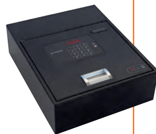
CAIXA FORTA D'OCULTACIÓ ARREGUI 9651074 BASA. Caixa forta per a sòcol electrònica motoritzada. 2 pernys de 12 mm de diàmetre. Dimensions: 110x310x380. Display lluminós amb data i hora en pantalla. Codi d'obertura i codi mestre de 6 dígits. Amb auditoria d'obertures dels últims 200 registres. Alimentació externa mitjançant pila de 9V. Disposa de clau d'emergència. La porta s'aixeca sola, un cop introduït el codi d'obertura, per l'acció d'un amortidor hidràulic interior. 112'90
