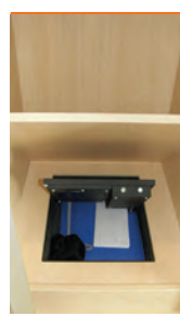
CAIXA FORTA D'OCULTACIÓ ARREGUI 9651074 BASA. Caixa forta per a sòcol electrònica motoritzada. 2 pernys de 12 mm de diàmetre. Dimensions: 110x310x380. Display lluminós amb data i hora en pantalla. Codi d'obertura i codi mestre de 6 dígits. Amb auditoria d'obertures dels últims 200 registres. Alimentació externa mitjançant pila de 9V. Disposa de clau d'emergència. La porta s'aixeca sola, un cop introduït el codi d'obertura, per l'acció d'un amortidor hidràulic interior. 112'90
