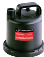
BOMBA TREBALL CONTINU AIGÜES NETES 9648098 Potència 80 W, Cabal 3000 l/h. Alçada màx. elevació: 3,1 m. Temperatura màx. líquid: 35°. Pas màx. de sòlids: 5 mm. No utilitzar en sec.
