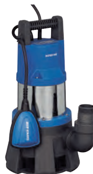
BOMBA SUBMERGIBLE AIGÜES BRUTES 9689967 Cabal màxim: 25.000 l/h. Potència: 1.300 W. Alçada d'elevació màxima: 11 metres. Profunditat d'immersió: 5 m. Mida màxima de partícules: 40 mm.
