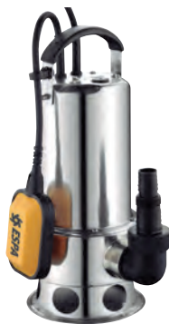
BOMBA SUBMERGIBLE AIGÜES BRUTES 9676312 1100 W, dià. màx. de sòlids: 35 mm). Alçada màxima: 7 m. immersió Cabal màxim: 18.000 litres/h. Material: Inox. Alçada màxima 8 mt.
