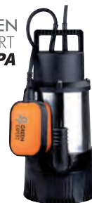
BOMBA SUBMERGIBLE AIGÜES NETES "GREEN EXPERT BY ESPA" 9680231 Material inox, amb 3 impulsors 800W. Motor elèctric de 230V. Alçada màxima: 30 m; immersió màx 7mt. Cabal màxim: 5500 l/h. Dià. Màx. sòlids: 0,5 mm.
