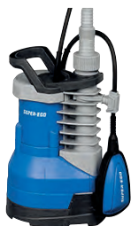
BOMBA SUBMERGIBLE AIGÜES NETES 9685471 Cabal màx 9.000l/h. 400W. Alçada elevació màx 8mt. Profunditat immersió màx 7mt. Partícules màx 5 mm.
