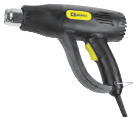
DECAPADOR DRAKO 9653245 K-DEC-2. 2000 W, 2 temperatures. Cabal d'aire 280-480 l/m. Inclou rascador, filtres per a diferents aplicacions i maletí.
