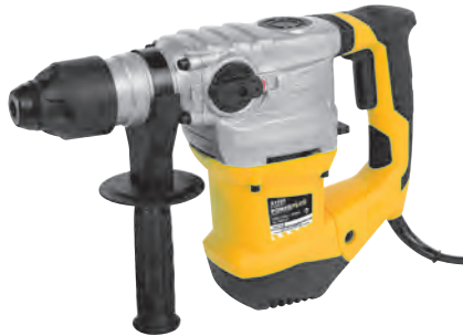
MARTELL COMBINAT POWERPLUS 9687673 POWX1195. 1500W. Potència d'impacte 6J. Portabroques SDS-PLUS. Capacitat màx. de perforació: 32 mm. 3 Funcions: Perforació/martell de perforació/cisellat.
