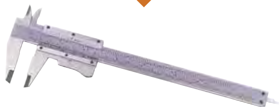
8421411010914 2016 / 150 mm. Calibre en acero al carbono mate antirreflejante con freno pulsante. Precisión 0.05 mm.
