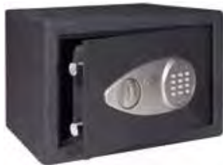
CAJA FUERTE SUPERFICIE BTV ALPHA. Apertura mediante teclado y pomo. Combinación de 2 a 6 dígitos. Espesor de la puerta 4mm, del cuerpo 1,5mm. 2 bulones de Ø18mm.
